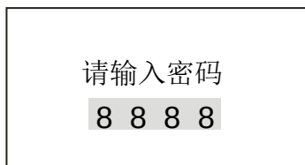
步骤 2 按“主菜单键”后提示输入密码为“8888”，按“选择键”选择更改位置，按“+键”或者“-键”更改数值大小，输入正确密码后按“确定”。
