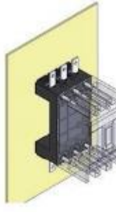
插入式板前接线 安装方式（Z3Q）
