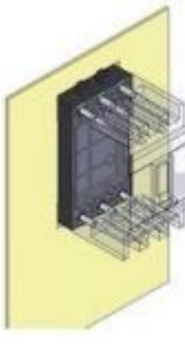
Z3H（方案二）： 大开孔式板后安装
